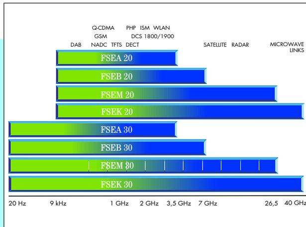
Die Option Vektor-Signalanalyse ist mit allen Analysatoren der FSE-Familie einsetzbar und deckt damit zukunftssicher den Frequenzbereich bis 40 GHz ab.
