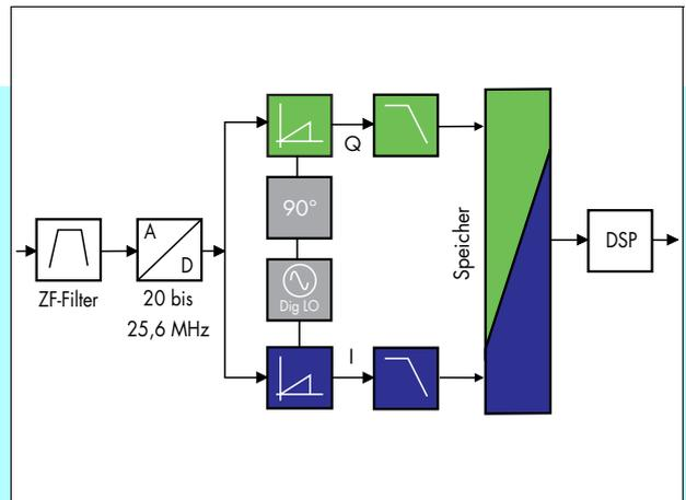
Funktionsprinzip der Option Vektor-Signalanalyse FSE-B7.
